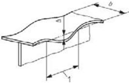
Deviazione $\Delta$ sulla lunghezza di misura 1 uguale alla larghezza della flangia $b$ (ondulazione della flangia) | $\Delta = \pm \frac{b}{150}$ se $b/t \leq 20$<br>$\Delta = \pm b^2 / (3000 t)$ se<br>se $b/t > 20$<br>$t$ = spessore flangia |
